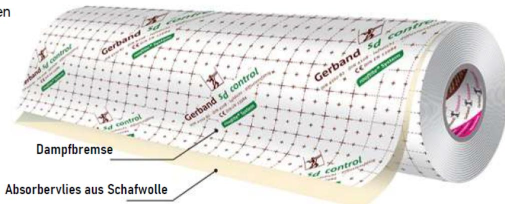
Um Kondensat unter der Konstruktion zu vermeiden empfehlen wir den Einbau unseres Tantum Absorbervlies mit Schafwollkaschierung. Es verhindert mögliche Tauwasserbildung unter der Oberflächenkonstruktion dauerhaft und sicher. Durch die Überbrückung der Holme und Streben kann zu 100% ausgeschlossen werden das eine Kältebrücke entsteht und sich z.B. an sehr schlecht zugänglichen Stellen Kondensat bildet.
